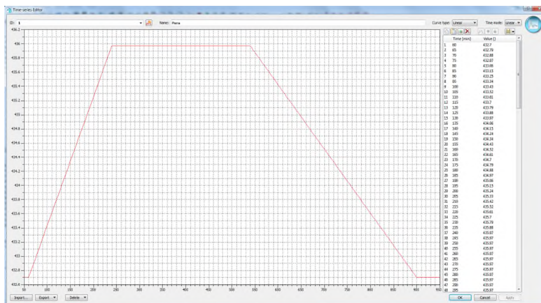
Fig. 4 Time series utilizzata per una delle sezioni in esame; l'aumento di livello fino a raggiungere la massima piena è lineare e ha durata 3 ore, il massimo livello viene mantenuto per 5 ore, mentre la discesa segue un andamento lineare con una durata di 6 ore.
